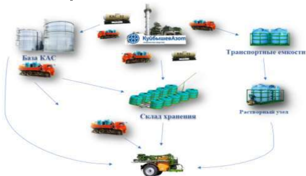
Рисунок 1- Общая логистическая схема доставки произведенных на ПАО «КуйбышевАзот» жидких удобрений КАС от завода до поля
