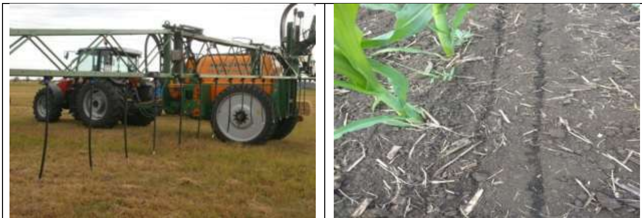
Рисунок 1 - Агрегат из опрыскивателя AMAZONE (АО«Евротехника») со шлангами-удлинителями для внесения КАС; следы КАС при внекорневой подкормке
